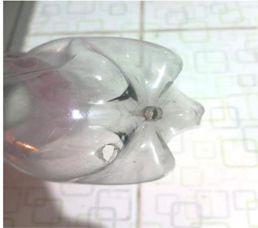
Figura 4. Paso 2, perforación con el clavo el polietileno tereftalato (PET).
