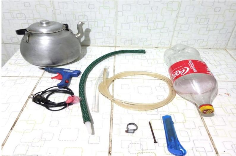
Figura 2. Materiales utilizados para la elaboración de la destiladora casera.
