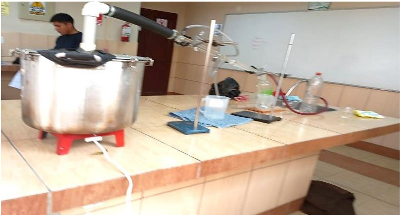
Figura 1. Destilador por arrastre de vapor
