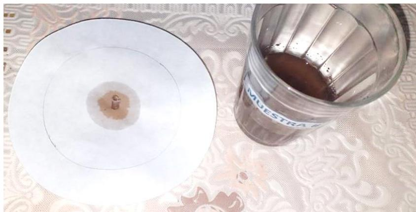
Figura 2. Papel filtro Whatman número 1 en proceso de impregnación con la muestra diluida.
