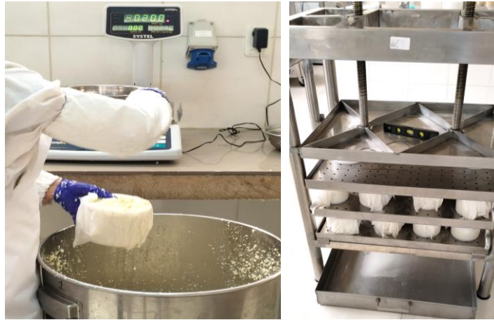
Figura 14. Pesado del queso (Izq.) y prensado del queso (Der.)
