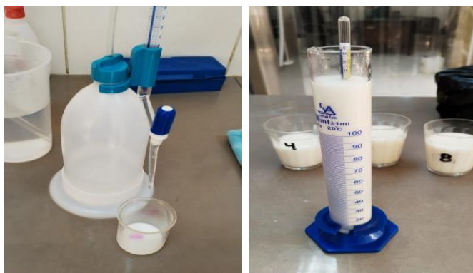
Figura 3. Titulación (Izq.) y medición de la densidad (Der.)
